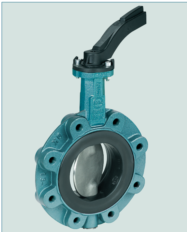
Přírubová klapka se závitovými oky v tělese. Umožňuje použití jako koncová armatura.
