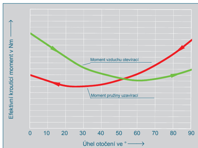
Průběh krouticího momentu pohonu s uzavíráním pružinou
